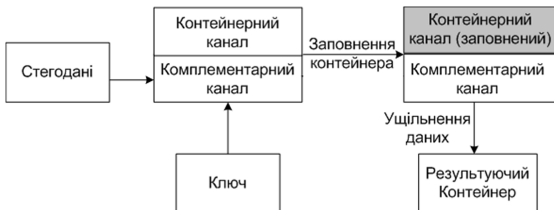
Рис. 1. Схема захисту даних в аудіо-файлі
