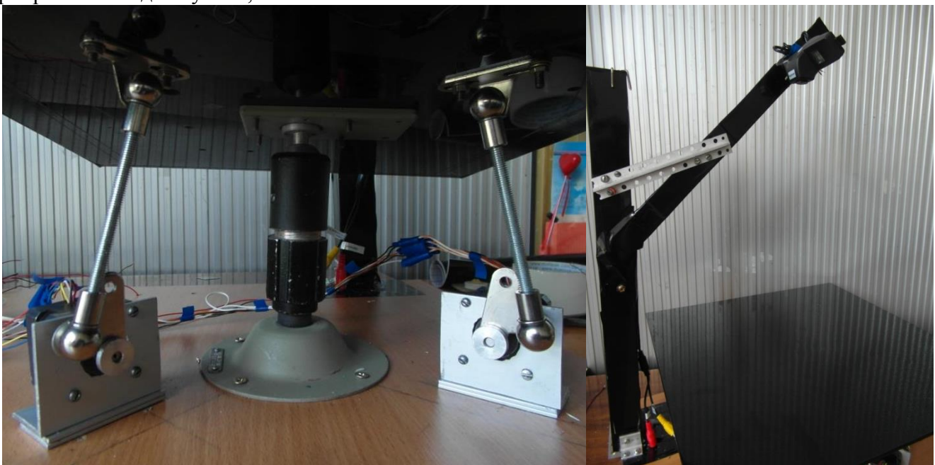
Рис. 1. Механізм керування платформою та відеокamera
